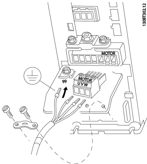
**Рисунок 1.7** Габарит корпуса H9
