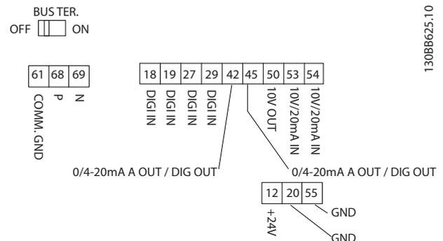
Рисунок 1.25 Клеммы управления
