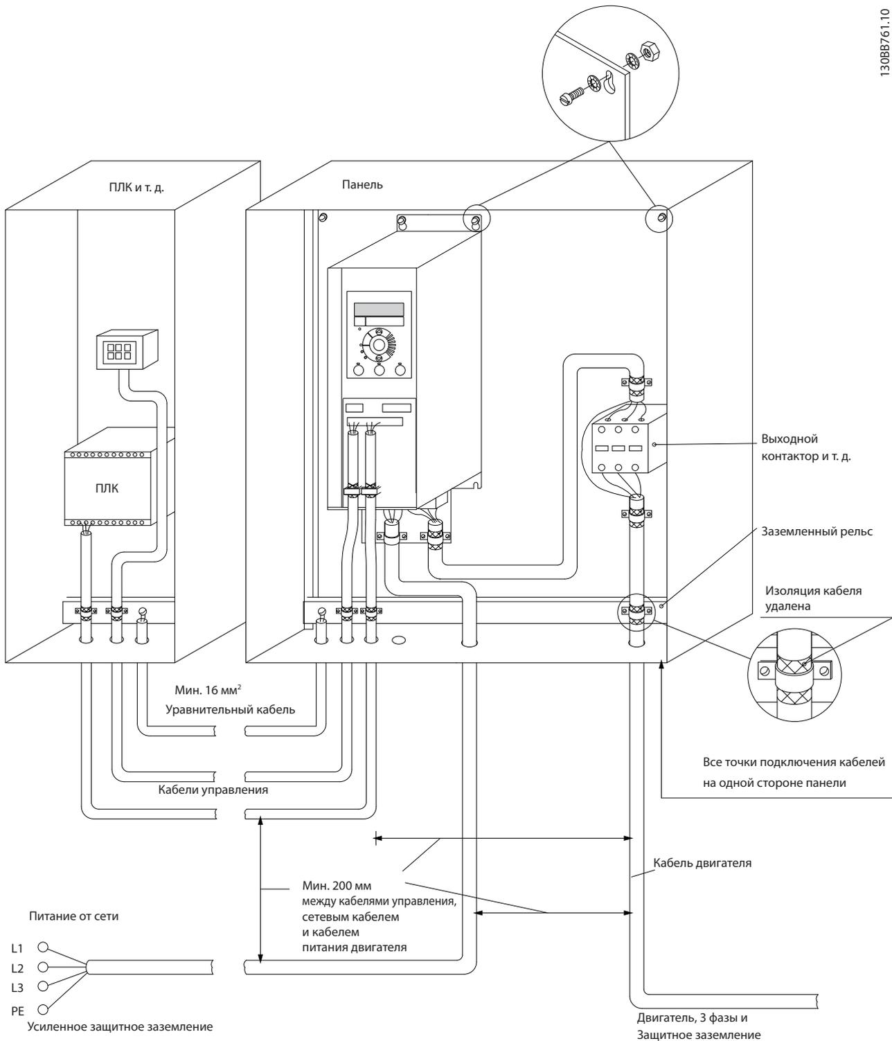
Рисунок 1.21 Электрический монтаж с учетом требований ЭМС
